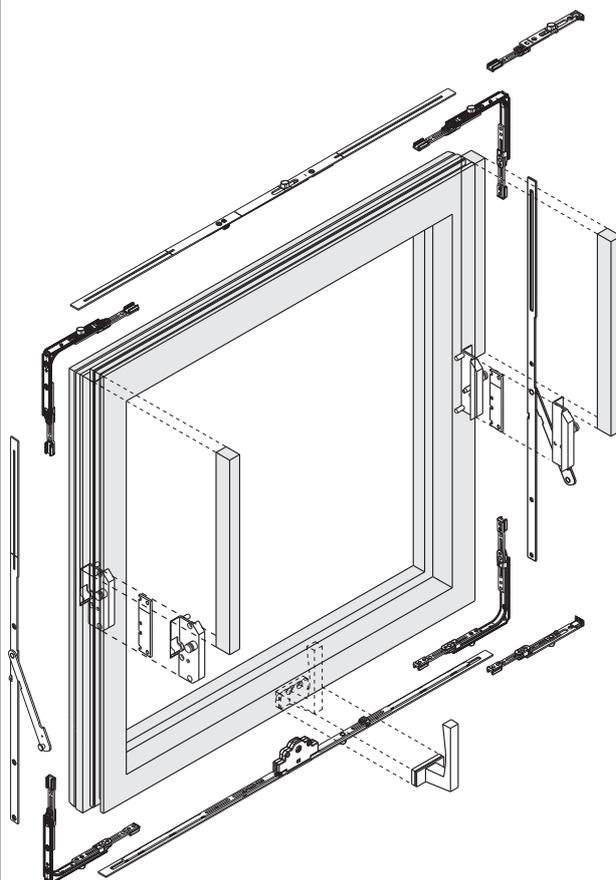
Montare la ferramenta sul battente
