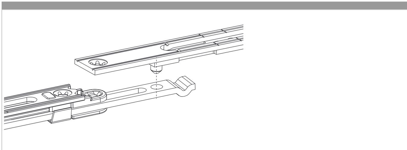
**Collegamento foro perno con scarpetta dentata**
