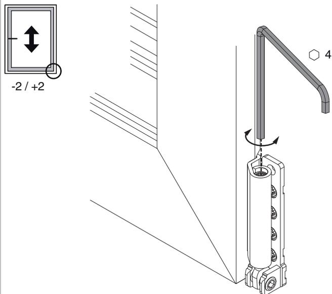
• **Regolazione:** L'angolo cerniera può essere regolato in altezza utilizzando una chiave a brugola da 4 mm (cod. 41017). Per migliorare la praticità di utilizzo, la vite di regolazione dell'altezza è stata costruita in modo che la chiave a brugola possa essere agganciata ogni 30°.
