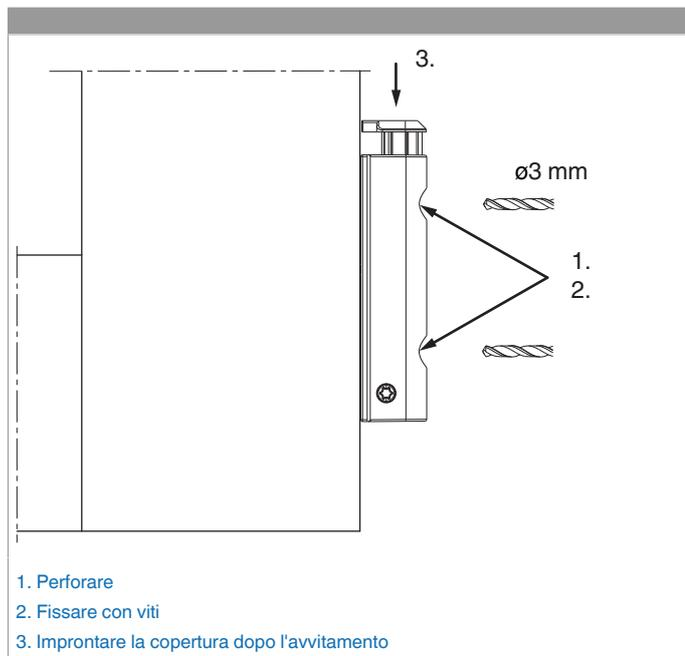
Appoggiare, perforare e avvitare alla battuta l'angolo cerniera doppia tazza con fissaggio battuta!
