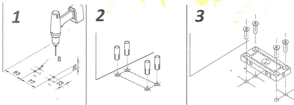
FISSAGGIO CERNIERE AL PANNELLO E AL SOFFITTO
