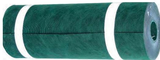
acustica. Grazie ad un valore elevatissimo di resistenza al vapore acqueo, la membrana funge anche da barriera a vapore contro l'umidità interna alla casa, prevenendo la comparsa di muffa perimetrale sul cassonetto. Il pannello è completamente riciclabile, costituisce un rifiuto non pericoloso e conferisce crediti LEED. È disponibile in rotoli da 11,5 m di lunghezza e di 60 cm di altezza.
