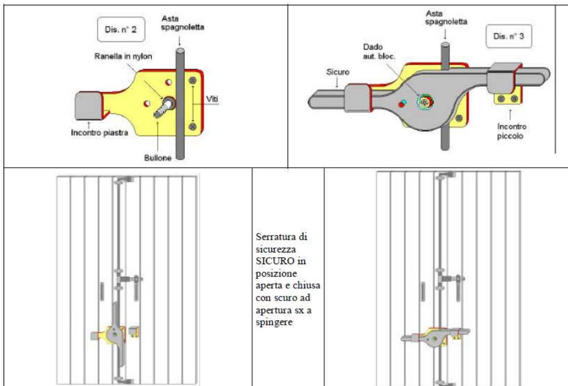
Serratura di sicurezza SICURO in posizione aperta e chiusa con scuro ad apertura sx a spingere
