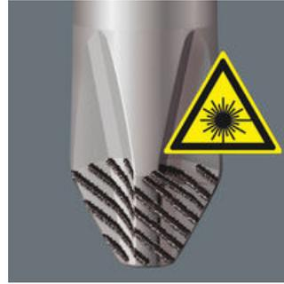
Tramite un raggio laser concentrato, si crea una superficie di strutturazione a spigolo vivo. La lama Lasertip della Wera si aggrappa saldamente nella testa della vite evitando che ne slitti fuori. Adatto per viti a taglio, Phillips e Pozidriv.
