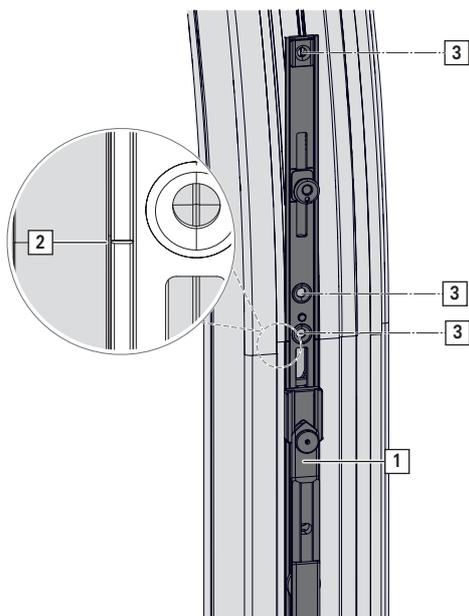
2. Montare la ferramenta completa. Attenersi alla sequenza di montaggio → *da pagina 299*.
