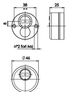
**ONE** - Mostrina e protezione per cilindri in acciaio temperato
