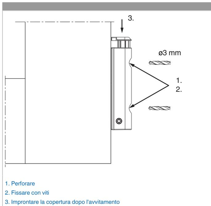
Appoggiare, perforare e avvitare alla battuta l'angolo cerniera doppia tazza con fissaggio battuta!
