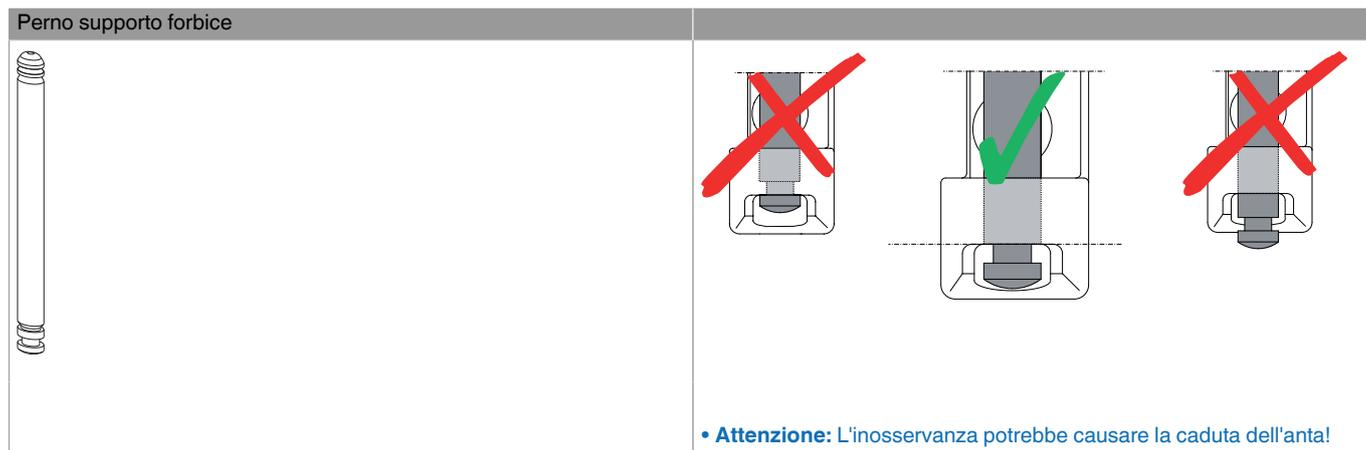
Le caratteristiche costruttive di supporto forbice, bandella forbice e perno supporto forbice provocano un effetto frenante con l'anta battente aperta rendendo in tal modo difficoltosa la chiusura automatica dell'anta.
