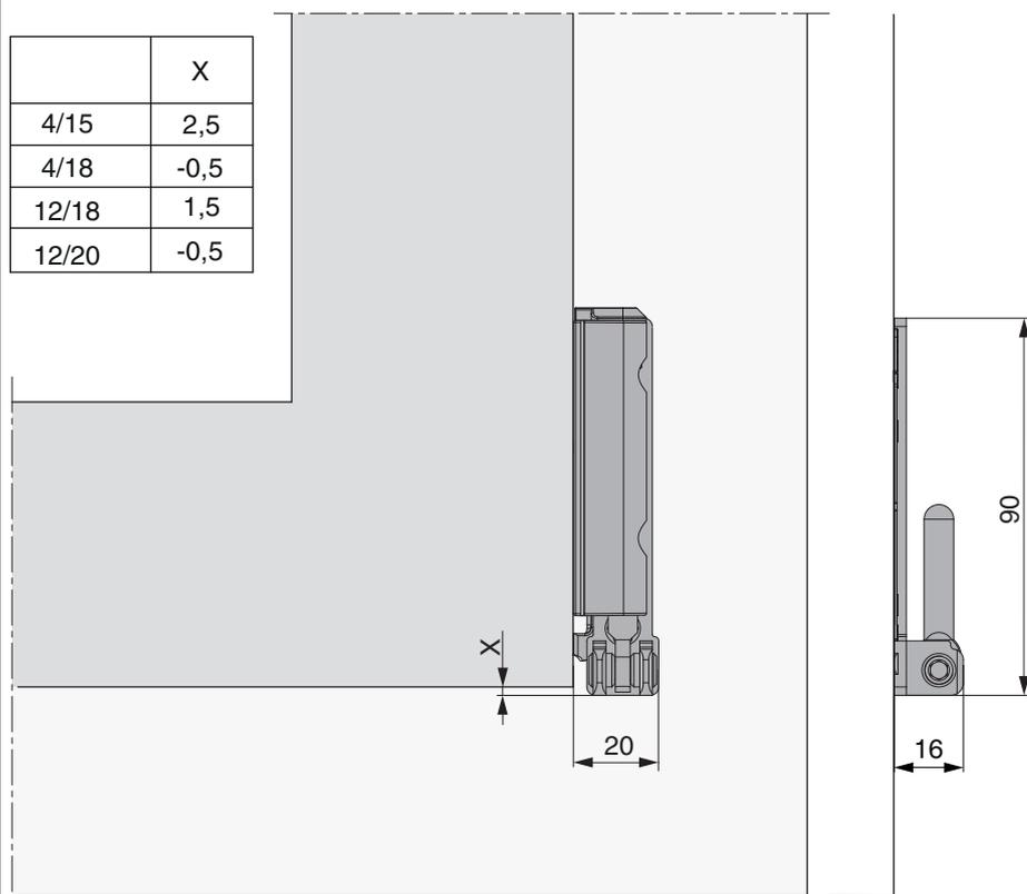
Con l'utilizzo delle coperture l'ingombro si riduce di +1 mm!
