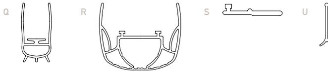
Joint en matière thermoplastique ignifuge mono-extrudé.
