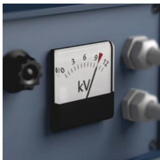
Il test individuale a 10.000 volt, in conformità con la norma IEC 60900, garantisce un lavoro sicuro con carichi fino a 1.000 volt.
