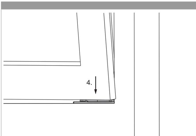
4. Inserire il battente leggermente inclinato a ribalta e parallelo al telaio, in entrambi i perni del supporto cerniera. Aprire il battente a 90°.
