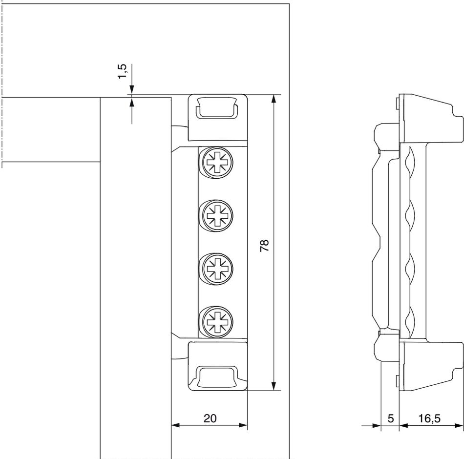
Con l'utilizzo delle coperture l'ingombro si riduce di +1 mm!
