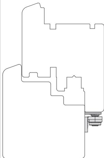
Montare il bloccafinestra per aerazione sull'altezza della maniglia con viti  $\varnothing$  4x40 mm.
