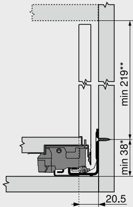
\* +1 mm in caso di montaggio della guida fianco prima di assemblare il corpo mobile
