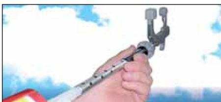
Si consiglia di avvitare l'accessorio sul tassello prima di inserirlo nel foro del muro così da rendere più semplice il suo posizionamento rispetto all'infisso e alla parete. Immettere anche un po' di ancorante chimico dentro il tubo forato del tassello.
