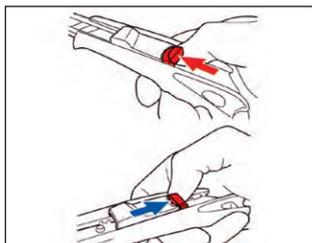
Regolare il fermalama per mantenere la posizione corretta della lama a spezzare
