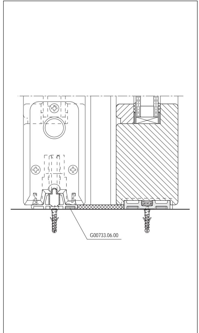
**1 Specifiche d'ordine - Profilo di sostegno a pavimento per anta fissa**
