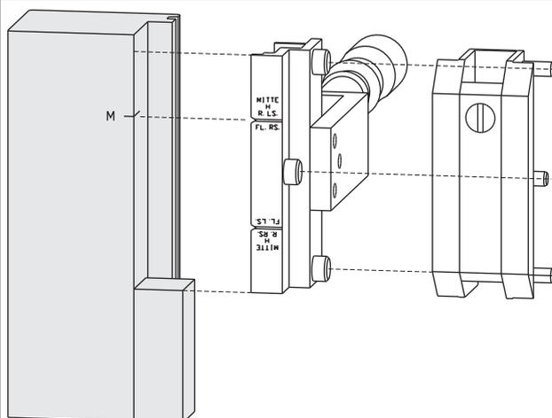
Sezione Bilico orizzontale cerniere 30 mm - 200 kg
