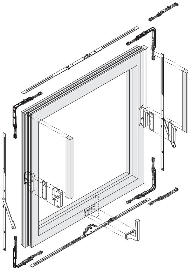
Montare la ferramenta sul battente
