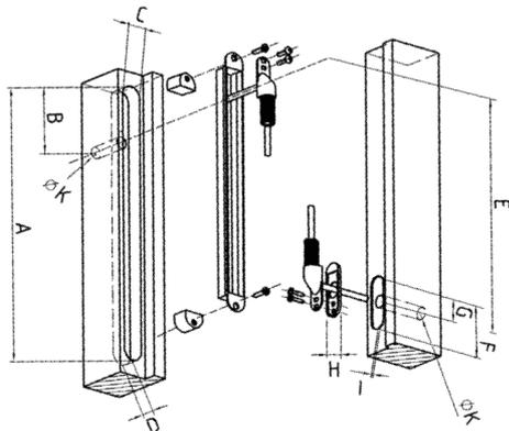
Fig. 3 Montaggio in legno
