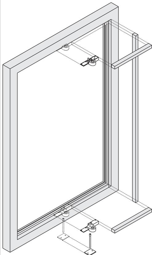
Montare le cerniere bilico verticale parte telaio.
