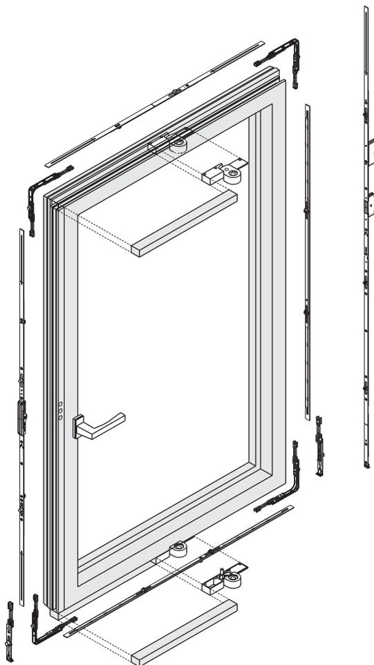
Montare la ferramenta sul battente
