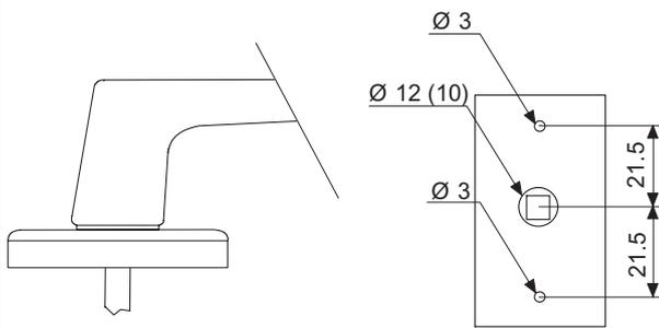
Adatta per profilati in PVC nei quali la struttura a camere e/o la presenza del rinforzo permette di avvitare direttamente sul profilato, anziché negli inserti.
