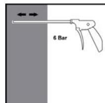
Soffiare 2 volte dal retro del foro (se necessario con una prolunga dell'ugello) su tutta la lunghezza con aria compressa senza olio (min. 6 bar a 6 m<sup>3</sup>/h). Spazzolare 2 volte con la dimensione della spazzola indicata (vedi tabella 6) inserendo la spazzola d'acciaio sul retro del foro (se necessario con una prolunga) con un movimento rotatorio e togliendola. X 2 Soffiare nuovamente con aria compressa almeno 2 volte.
