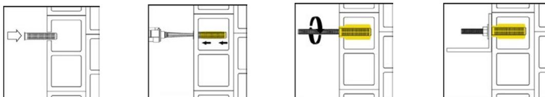
Introdurre il manicotto di dimensioni adeguate. Inserire l'ugello all'estremità del manicotto e iniettare la resina fino a quando il manicotto si riempie al 100%. Inserire l'ancoraggio, lentamente con un leggero movimento rotatorio nel manicotto. Rimuovere la resina in eccesso e lasciare il fissaggio fino a che non sia trascorso il tempo minimo di indurimento (carico).
