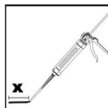
Rimuovere il tappo filettato dalla cartuccia. Fissare saldamente l'ugello di miscelazione. Non modificare il miscelatore in alcun modo. Assicurarsi che l'elemento di miscelazione sia all'interno del miscelatore. Utilizzare solo il miscelatore in dotazione. Inserire la cartuccia nella pistola erogatrice. Scartare i primi tiri di adesivo. Scartare i primi 10ml di resina.
