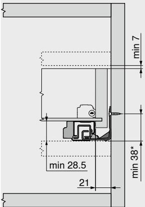
\* +1 mm in caso di montaggio della guida prima di assemblare il corpo mobile
