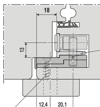
**NB.** In queste applicazioni fissare il deviatore con le viti in battuta come indicato dalla freccia e con le viti della martellina. Non fissare con viti M5 al cremonese.
