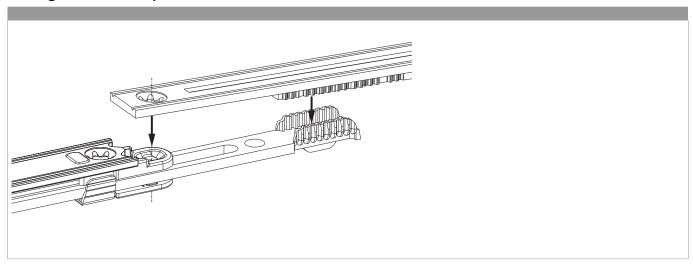
209637 - Terminale per asta a leva MM bilanciere inferiore con uscita puntale argento
