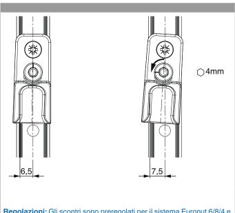
**Regolazioni:** Gli scontri sono preregolati per il sistema Euronut 6/8/4 e si adattano all'applicazione a destra o a sinistra. Con il sistema Euronut 7/8/4 regolare la pressione a destra o a sinistra con la chiave a brugola codice articolo 41017
