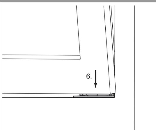
6. Inserire il battente leggermente inclinato a ribalta e parallelo al telaio, in entrambi i perni del supporto cerniera. Aprire il battente a 90°.
