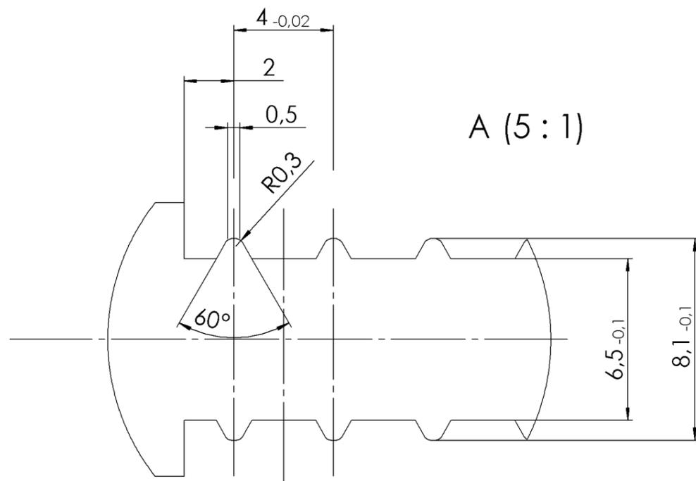
Treibstangen-Lochungen & Verzahnung sind symmetrisch zur Mittenachse toleriert!
