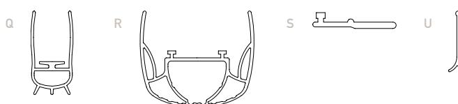
Guarnizione in materiale termoplastico antifiamma monoestruso.
