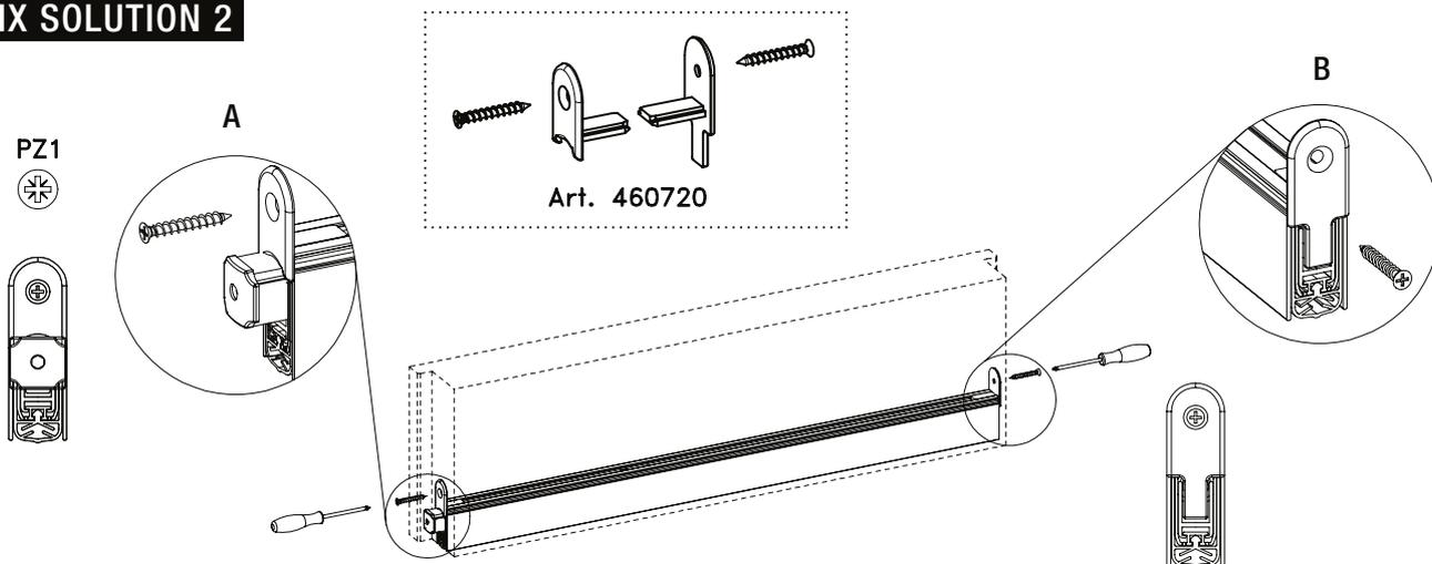
Per il montaggio con squadretta deve essere ordinato a parte l'articolo 460720 (Squadrette di fissaggio e viti) insieme alla guarnizione sottoporta DB54!
