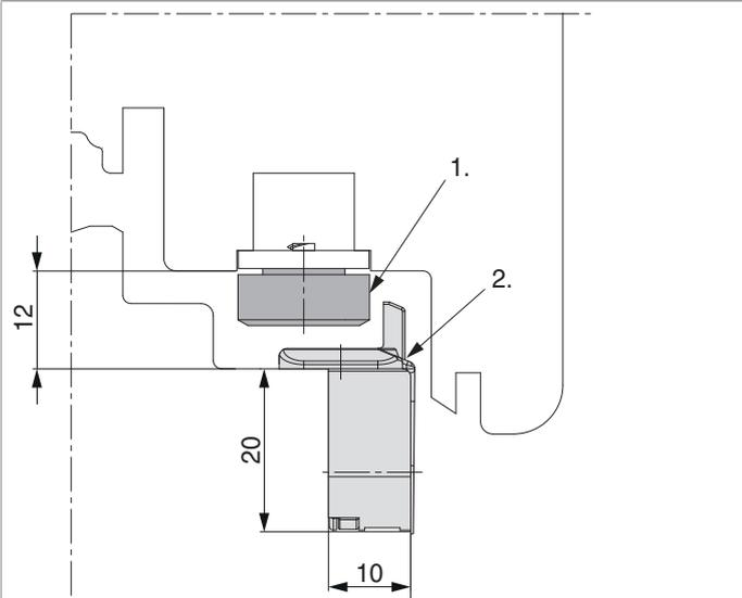
1. Avvitare il perno al movimento angolare orizzontale con la vite fornita serrando al massimo con 4 Nm.
