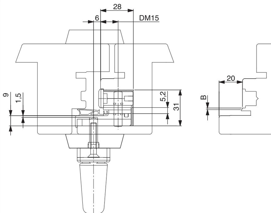
Disegno di montaggio profilo A12/AB18/sc. 9 con guarnizione in battuta grande, distanza cava ferramenta 1 mm
