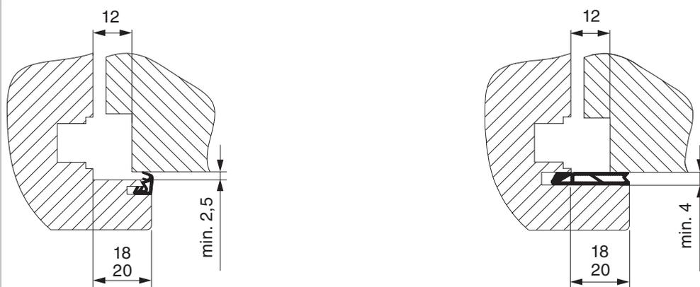
1. Per finestre senza guarnizione in battuta è assolutamente necessario una fresatura sulla battuta!
