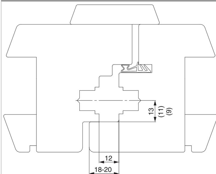
Profilato ad U in alluminio per cava ferramenta per asta a leva
