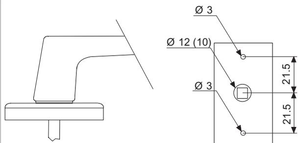
Adatta per profilati in PVC nei quali la struttura a camere e/o la presenza del rinforzo permette di avvitare direttamente sul profilato, anziché negli inserti.
