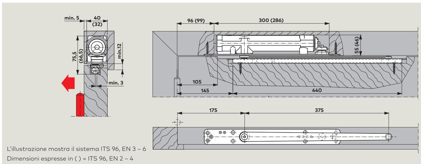
Chiudiporta ITS 96 con braccio a slitta G 96 N20 in una porta in legno con fissaggio ad architrave.
