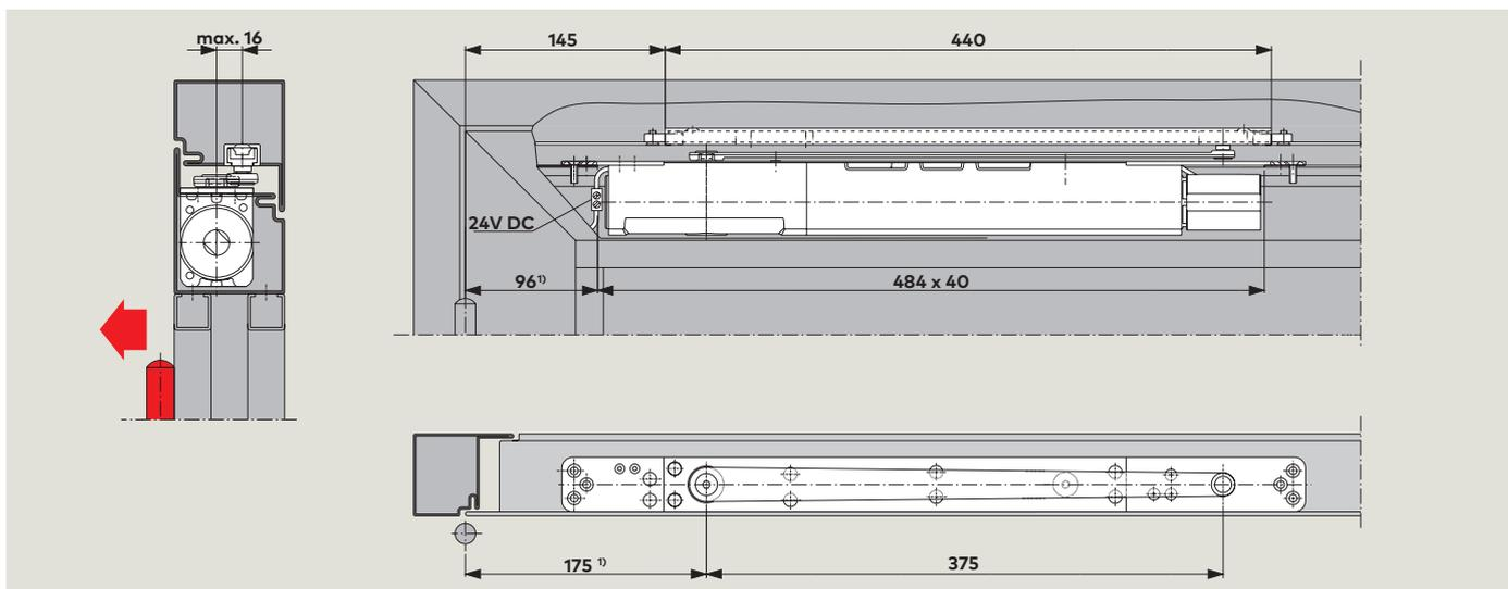
Chiudiporta ITS 96 FL con braccio a slitta G 96 N20 in una **porta con telaio in alluminio**. Esempio: porta a chiusura in senso antiorario (ISO 6);
