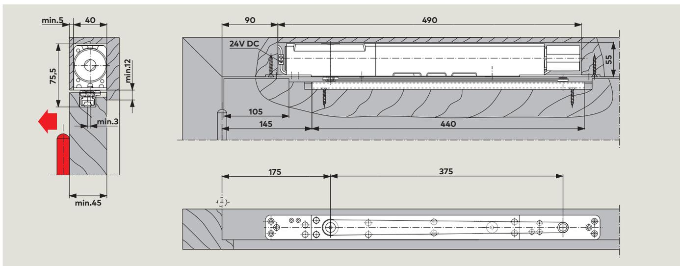
Chiudiporta ITS 96 FL con braccio a slitta G 96 N20 in una porta in legno con fissaggio ad architrave.
