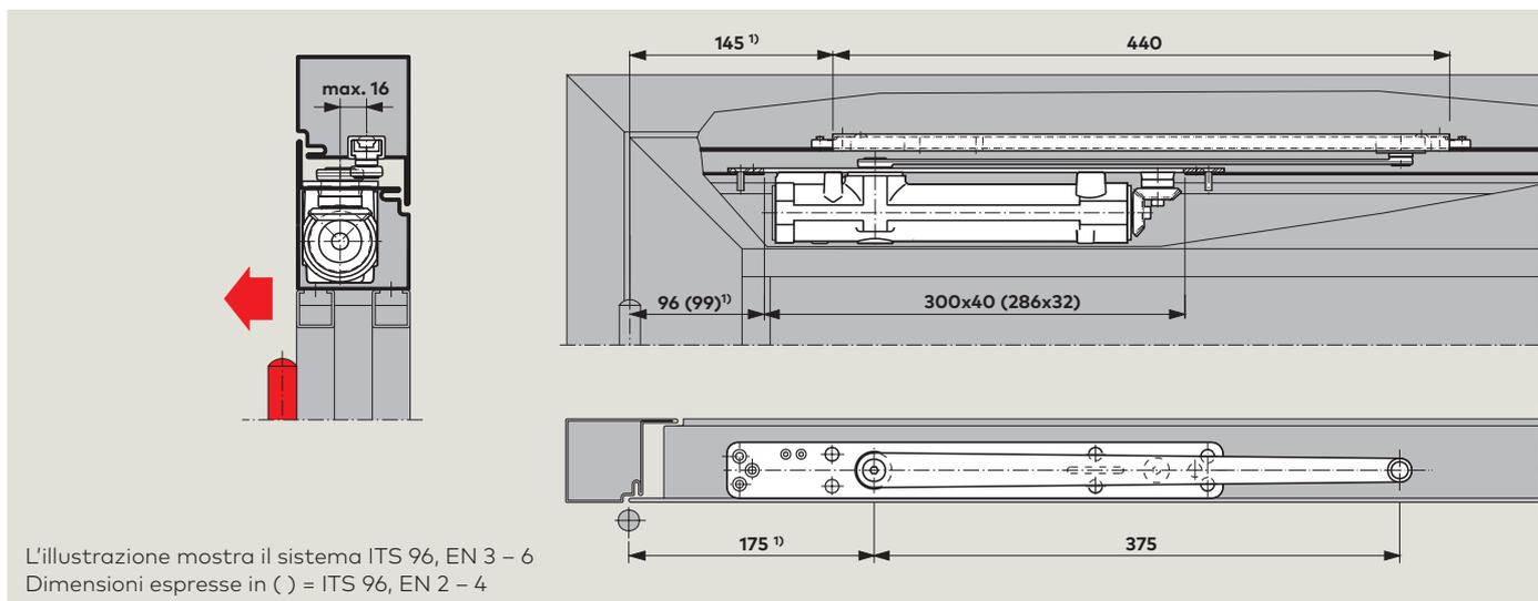
Chiudiporta ITS 96 con braccio a slitta G 96 N20 in una porta con telaio in alluminio. Esempio: porta a chiusura in senso antiorario (ISO 6); l'immagine speculare si applica per porte con chiusura in senso orario (ISO 5). Aggiungere 25 mm su telai con angolo di rinforzo.
