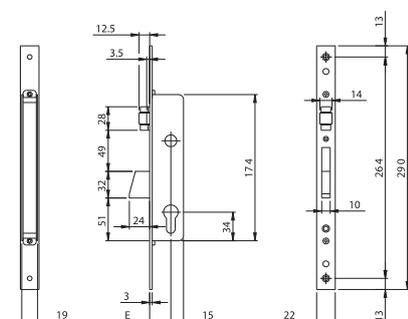
Serratura da infilare per montanti, CHIUSURA LATERALE, cilindro a profilo europeo.
