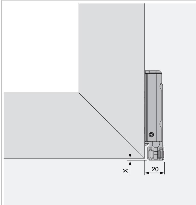
Con l'utilizzo delle coperture l'ingombro si riduce di +1 mm!
