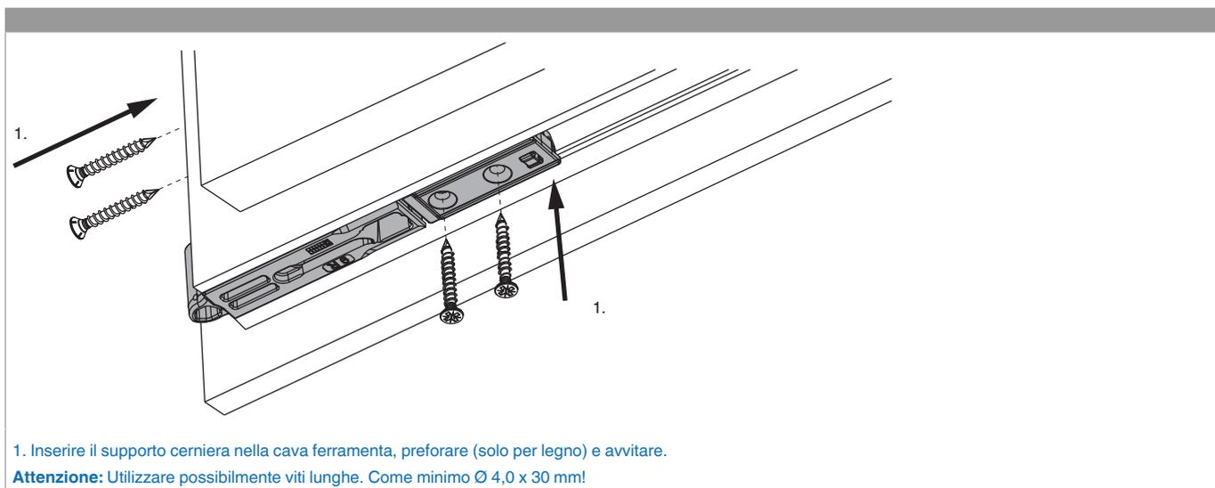
1. Inserire il supporto cerniera nella cava ferramenta, preforare (solo per legno) e avvitare.
